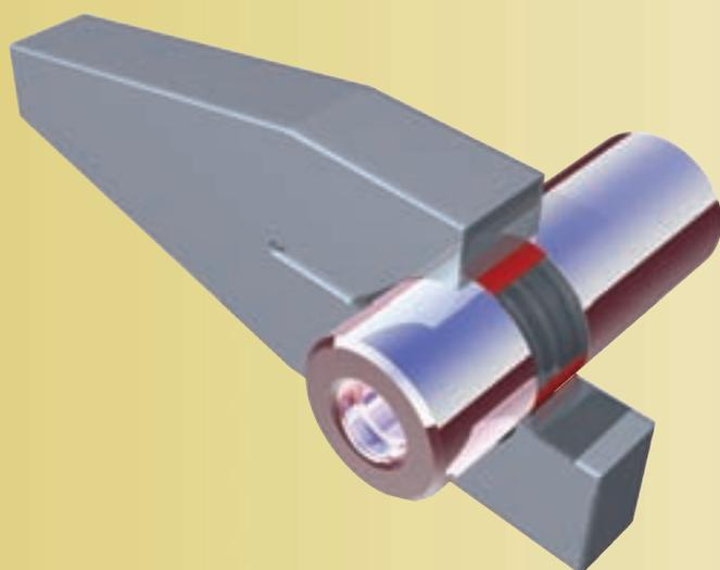
Восстановленный вал для зажимного соединения с втулкой
