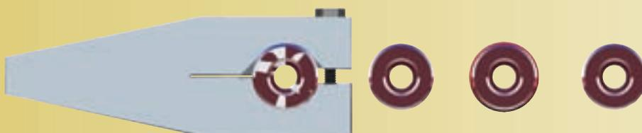
Восстановление поверхности вала для зажимного соединения
